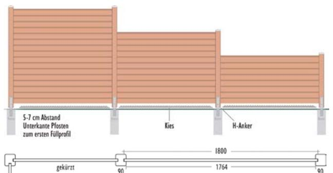
**TIPP:** Das Füllprofil ist 1800 mm lang und die Nut am Pfosten je 20 mm tief. Damit die Füllprofile beim Einschieben passen, nehmen Sie bitte das genaue Abstandsmaß von 1764 mm zwischen den Pfosten. In diesem Maß sind je 2 mm Luft auf jeder Seite eingerechnet, damit das Holz noch „arbeiten“ kann.
