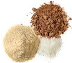
Unser polymergebundener Holzwerkstoff besteht aus bis zu 75 % Holzfasern. Diese werden zerkleinert und im trockenen Zustand mit Polymeren (recycelter Kunststoff) und Additiven (Bindemittel und Farbe) vermischt. Die eingesetzten Polymere dienen dabei als „Klebstoff“ und halten die Naturfasern zusammen.
