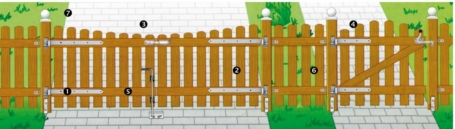
1 Pfostenanker 2 Elementhalter 3 Überwurf 4 Torfalle 5 Bodenschieber 6 Ladenband 7 Pfostenkappe
