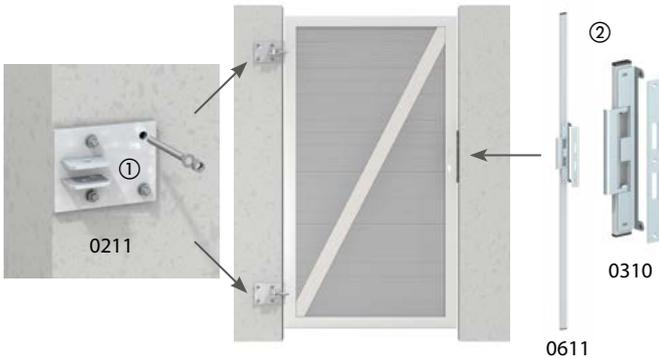
① **Montageplatte** für die Montage von Toren direkt an einer Hauswand oder Mauer (ohne Torpfosten). Stahl, feuerverzinkt, B x H: 15,5 x 12 mm, Stärke 10 mm. *Schrauben für die Montage bitte separat besorgen.*
