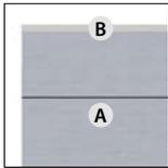
**Profil (A):** 6 WPC-Nut-Feder-Profile, 309 x 21 mm, 30 cm sichtbare Höhe, beidseitig glatt
