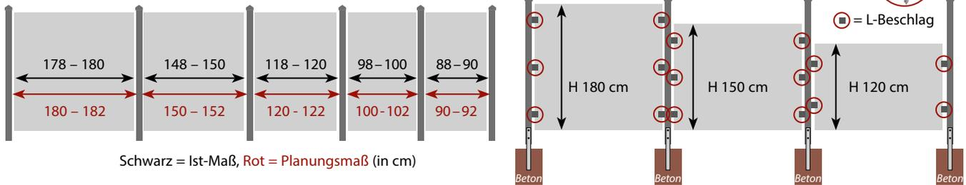
Um die Pfostenabstände richtig festlegen zu können **alle Elemente vorher genau ausmessen**, da diese durch Fertigungstoleranzen variieren können.
